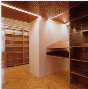
Alle Holzeinbauten sind aus Betonschalplatten. Interessant ist die Konstruktion der Bücherregale: Eine Aluminiumwand bildet den Korpus, die Fächer (Betonschalplatten) sind nur gesteckt!
